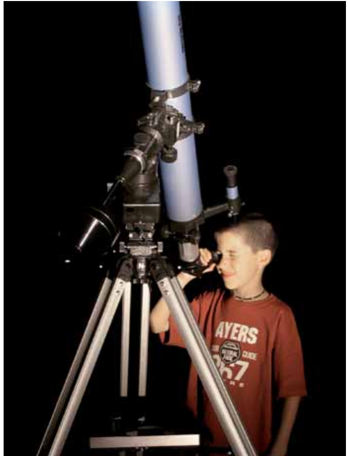
Fig. 1.- Telescopi refractor de 120 mm d'obertura, de baix cost i de fàcil maneig. El seu pes obliga que l'adult ajudi a l'infant a transportar-ho i a muntar-ho o desmuntar-ho.
