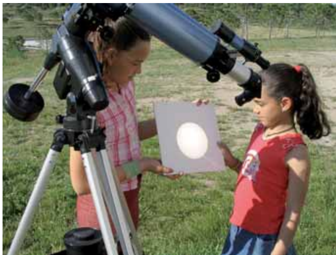
Fig. 3.- Mètode de projecció solar sobre una pantalla.
