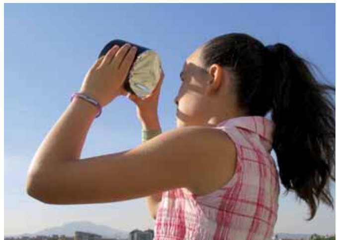
Fig. 1.- Observació del Sol a simple vista amb el més idoni dels filtres: el que s'utilitza a la boca del telescopi i que és especial per a l'observació directa. S'assembla a un «paper» d'alumini de cuina, però no ho és en absolut. Pot adquirir-se en comerços especialitzats en instrumental astronòmic o a l'Agrupació Astronòmica de Sabadell, i enganxar-ho a un suport realitzat amb una cartolina.
